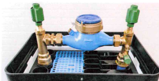
Ventil před i za vodoměrem, včetně zpětné klapky s odvzdušněním, pro vodoměr DN20 (závit 1")
